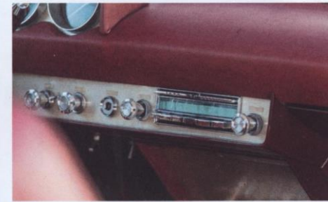
Pfusch am Bau: Die Cockpit-Abdeckung ist überaus unfachmännisch in Leder gehüllt. Links neben dem serienmäßigen Town-and-Country-Radio fehlt kein Bedienknopf, dort sitzt das Zündschloss
